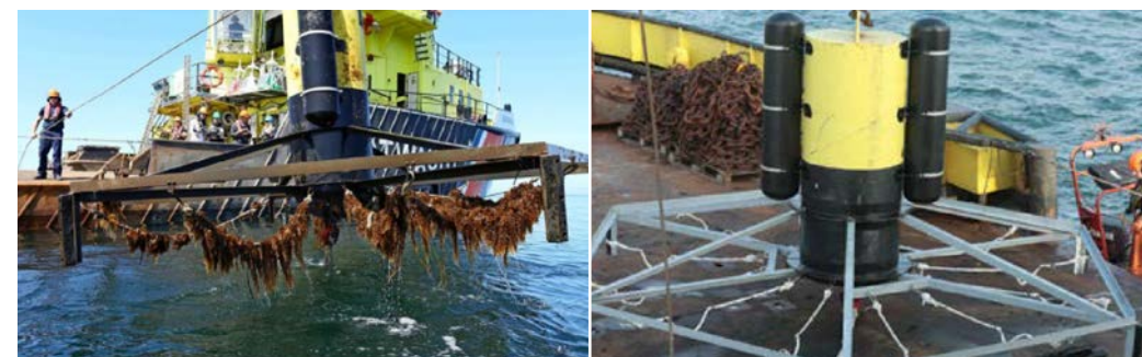
Eerste zeewierproductiesysteem dat in 2015 werd gebruikt door North Sea Farmers. Het is een wielgebaseerd systeem met een diameter van 5 meter. Het zeewier werd gekweekt op een diepte van ongeveer 2 meter.
